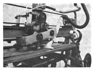
Tretrad nach Lisson. Die vier Füsse sind mit einem Sohlenmaterial belegt und bewegen sich mit einem Schlupf von 20 % über die ge-spannte Teppichprobe, die an der Vorderkante eine Art Treppenabsatz bildet
