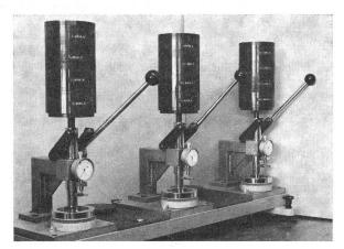
Stuhlbeintest (statische Prüfung auf Zusammendrückbarkeit). Die Stempel werden unter bestimmter Belastung in den Bodenbelag eingedrückt, und die Messuhren erlauben die Bestimmung der Eindrucktiefe direkt nach der Entlastung und nach einer Erholungszeit.
