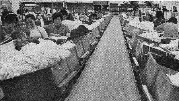
Arbeitsplätze an einem der zur direkten Arbeitsplatzbeschickung dienenden Schnellbänder
