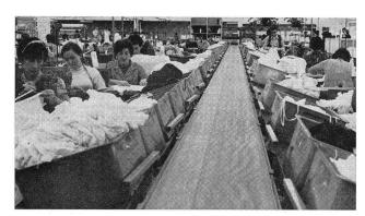
Arbeitsplätze an einem der zur direkten Arbeitsplatzbeschickung dienenden Schnellbänder
