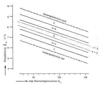
Abbildung 4 Klassierung für die Reissdehnung peignierter Baumwollgarne Im vorliegenden Beispiel besteht zwischen der Reissdehnung und dem Drehungskoeffizienten keine statistisch gesicherte Korrelation. Trotzdem wurde die rechnerisch festgestellte, sinngemässe Zunahme der Reissdehnung mit steigendem Drehungskoeffizienten in die Mittelklasse einbezogen, wegen dieser Unsicherheit aber nur eine dreiteilige Klassierung gewählt.
