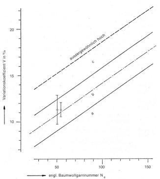
Abbildung 6 Klassierung für die Gleichmässigkeit in der Reisskraft (Variationskoeffizient) peignierter Baumwollgarne
