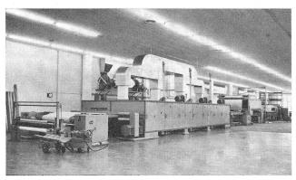
Gesamtansicht der Ausrüststrasse, vorn der gasbeheizte Spannrahmen
