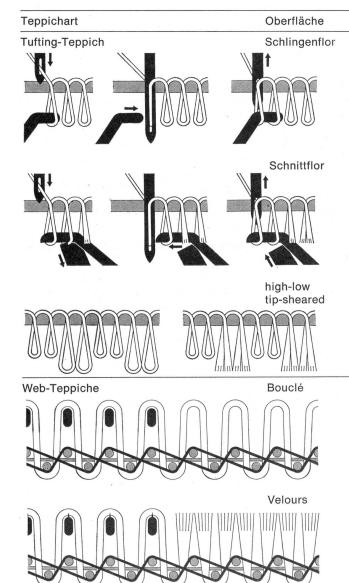
Das Tuften ist eine modifizierte Nähtechnik, bei der die Florfäden mittels nebeneinander aufgereihten Nadeln in ein vorgelegtes Trägergewebe oder synthetisches Faservlies eingestochen werden. Beim Herstellen von Schlingenflor-Tuftings halten kleine Greiferhaken die durchgestochenen Florfäden fest, wodurch beim Zurückgleiten der Nadeln Schlingen entstehen. Damit die Florschlingen im Trägergewebe beziehungsweise Vlies festhaften, wird der Teppichrücken anschliessend mit Latex beschichtet.
