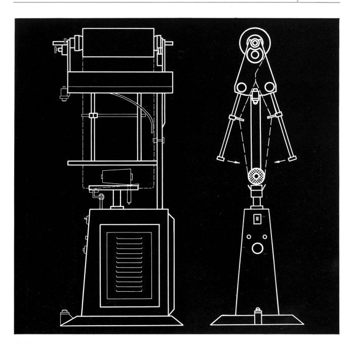
Fertigbeutel nach Mass mit der halbautomatischen Konenverpackungsmaschine
