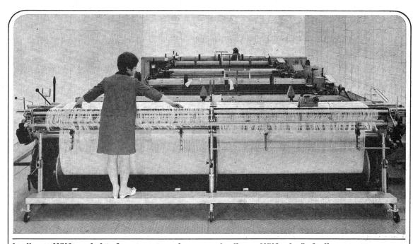
In dieser Hälfte wird aufgespannt, und zwar geht das dank unserer besonderen Methode sehr schnell und einfach... ...in dieser Hälfte knüpft die USTERMATIC-Knüpfmaschine mit einer Leistung bis zu 600 Fd/min.
