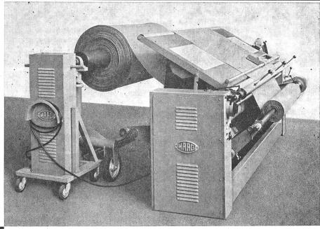
Moderne Beschaueinrichtung CT 5206 Ah/B für Wirkware, mit spannungsfreiem Warendurchlauf ab separat angetriebener Grosskaule / Exakte Längenmessung durch eichfähige Messvorrichtung / Automatische Kantenführung beim Aufrollen, leichte Bedienung
