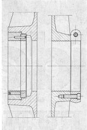
Gewindekettbäume mit tangential verrippten Scheiben für alle Belastungsarten, In- und Ausland-Patente. Höchste Belastbarkeit bei kleinster Deformation.
