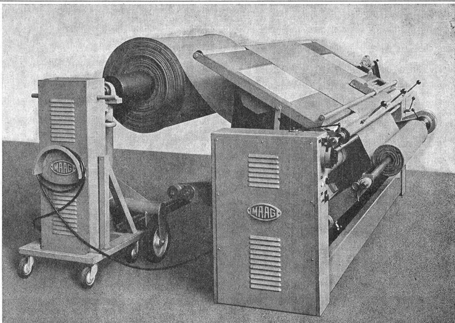
Moderne Beschaucheinrichtung CT 5206 Ah/B für Wirkware, mit spannungsfreiem
