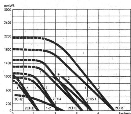
\*) serienmäßig angebauter Motor mit 1,1 kW reicht nur für den gezeichneten Kennlinienbereich. Wenn der Betriebspunkt über 1000 mm WS liegt, sollte das Gebläse verwendet werden.
