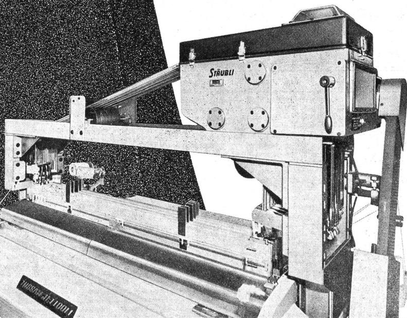
Für jede Webmaschine gibt es eine geeignete Schaftmaschine von Stäubli.
