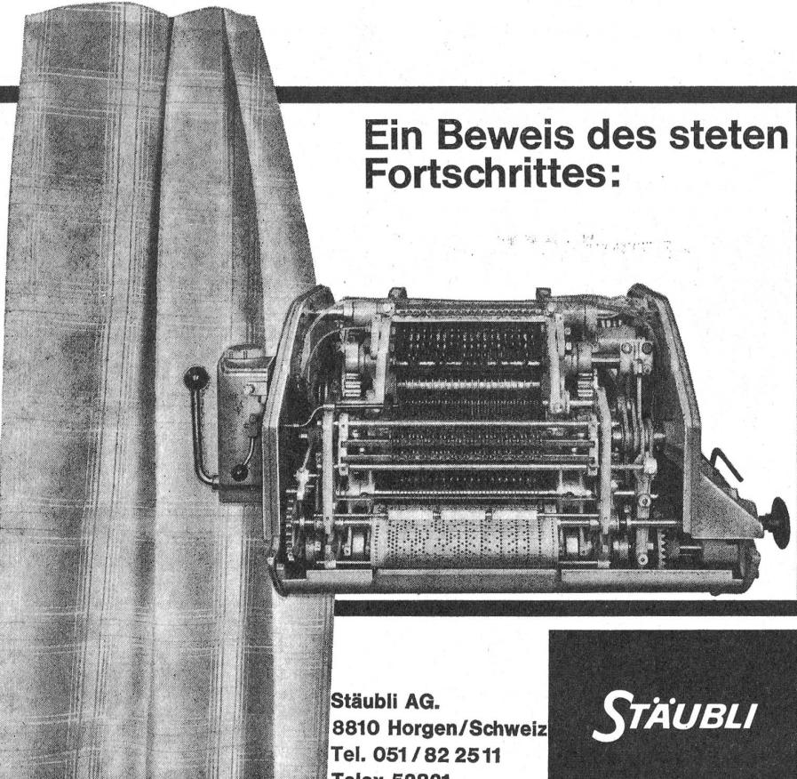
Die neue Hochleistungs-Gegenzugschaffmaschine Typ LEZSRDO mit Zentralschmierung
