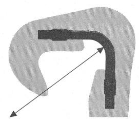
diese Metalleinlage eine Härte von HV 1700 hat, was derjenigen des Edelsteins Topas entspricht, und somit beim Fadenschnitt maximalen Widerstand bietet.
