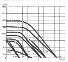
\*) serienmässig angebauter Motor mit 1,1 kW reicht nur für den gezeichneten Kennlinienbereich. Wenn der Betriebspunkt über 1000 mm WS liegt, sollte das Gebläse verwendet werden.
