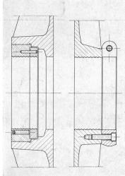
Gewindekettbäume mit tangential verrippten Scheiben für alle Belastungsarten, In- und Ausland-Patente. Höchste Belastbarkeit bei kleinster Deformation.
