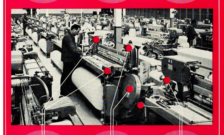
Weitere Punkte die Ihnen wesentliche Vorteile bringen: Geringe Wartung Kein Ölen Kein Schmieren Wenig Verschleiss durch automatische Zentralschmierung Ölbad und dauergeschmierte Kugellager
