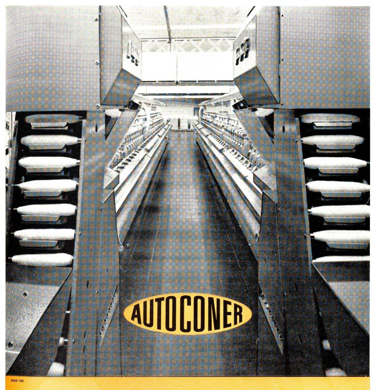
AUTOCONER, der Kreuzspulautomat für den fortschrittlichen und qualitätsbewußten Textilbetrieb—jetzt mit automatischer Kopszuführung.
