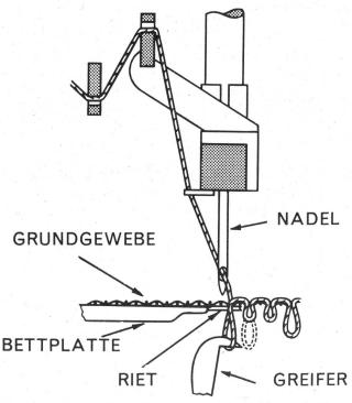
Abb. 3 Die Nadeltätigkeit einer Schlingenteppich-Tuftingmaschine
