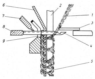
Abb. 5 Schematische Skizze der Nähwirkwerkzeuge für das Voltexverfahren: 1 Faservlies, 2 Polplatine, 3 Vorrichtung zur Vliesvorlage, 4 Schiebernadelhaken, 5 Polhenkel, 6 Grundbahn, 7 Schliessdraht, 8 Schiebernadel, 9 Abschlagplatine
