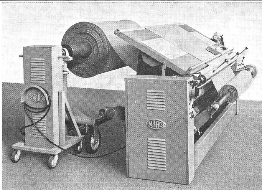
Moderne Beschaeueinrichtung CT 5206 Ah/B für Wirkware, mit spannungsfreiem
