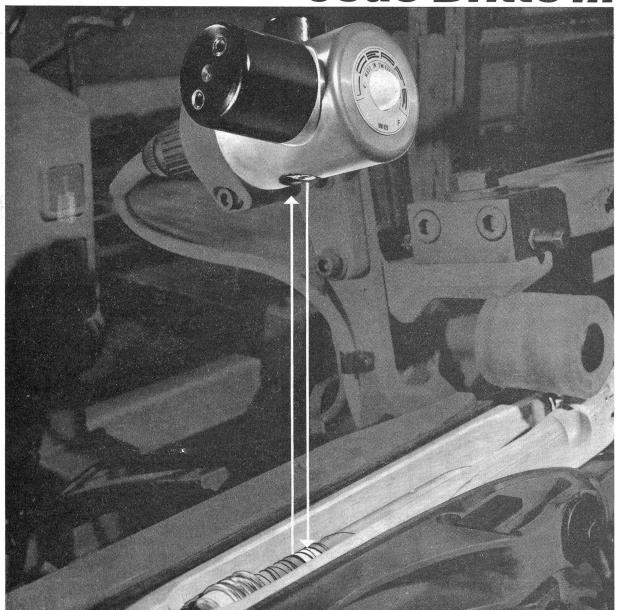
...moderne Schützen-Webmaschine, welche heute die Fabrikation verlässt, wird mit dem optisch-elektronischen Loepfe-Schussfühler ausgerüstet. Ein überzeugender Beweis für seine Zuverlässigkeit! Die bekannten Fehlerquellen bei der Schussspulen-Überwachung können endgültig behoben werden. Der Loepfe-Fühler bringt Gewinn!
