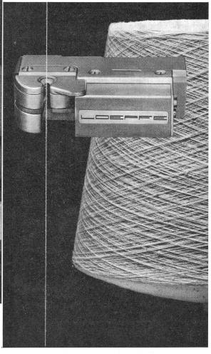
Welche Reinigung Sie auch erreichen wollen, wichtig ist, dass Sie mit einem Reiniger arbeiten, der genau jene Fehler und nur diese heraus-schneidet, die Sie als störend betrachten. Beim Loepfe-Reiniger wird die genaue Selektivität durch drei getrennte Auswertekanäle erzielt, d.h. jede Fehlerart wird sowohl nach ihrer Länge als auch nach ihrer Dicke beurteilt. Dieses Arbeitsprinzip lässt Sie die wirklich gewünschte Garnqualität erreichen. Deshalb: Loepfe-Reiniger!
