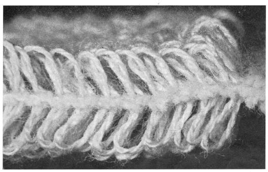
Abb. 4 Querschnitt eines Frottiergewebes in Kettrichtung
