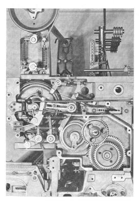
Abb. 9 Florschaltung mit geöffnetem Getriebedeckel
