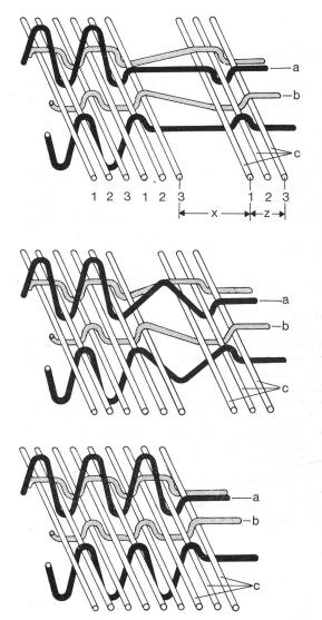
Abb. 3 Schematische Darstellung der Schlingenbildung: a Florkettfaden, b Grundkettfaden, c Schussfaden (1, 2, 3), x Vorschlagdistanz, z Vorschlaggruppe
