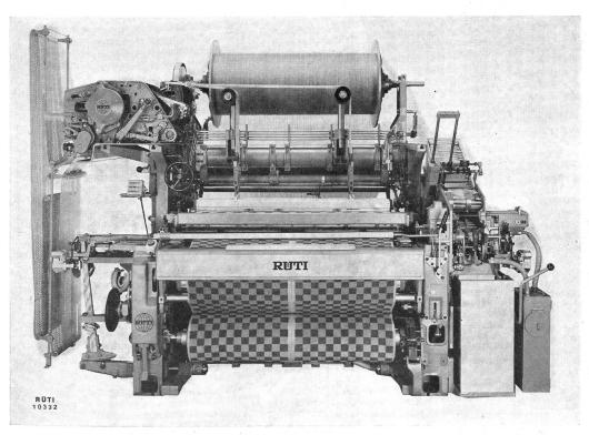
Abb. 6 C-Frottierwebmaschine
