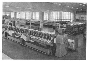
Spulmaschinen mit elektronischer Fadenreinigung bürgen für Qualität
