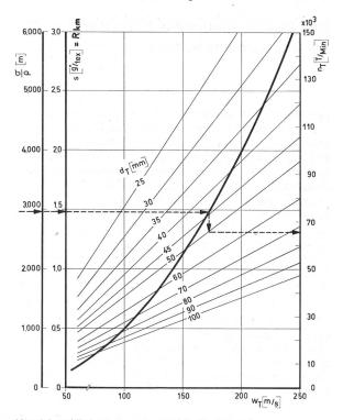
Material- und Fadenspannungsgrenzen bei Turbinenspinnen
