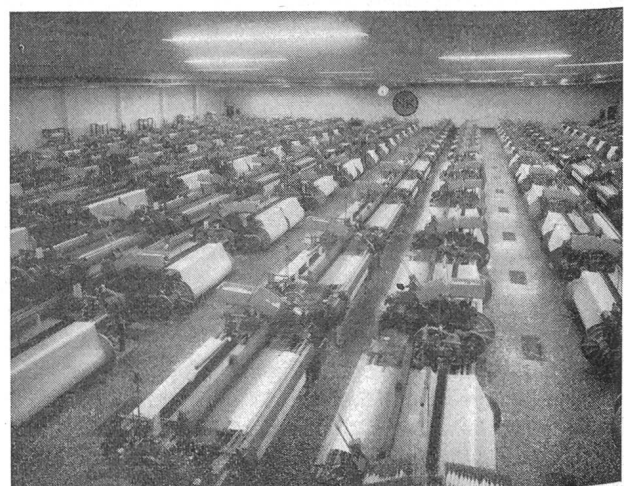
Websaal mit Rütli-Schnellläufer-Webmaschinen, Typ BANLXKM, ausgerüstet mit Grossmagazin
