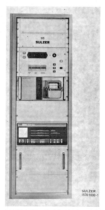
Zentraleinheit des «Systems 913» mit Steuerteil, Bedienungspult, Papierstreifendrucker, Klein-Computer, Lochstreifenstanzer und Versoraunasteil
