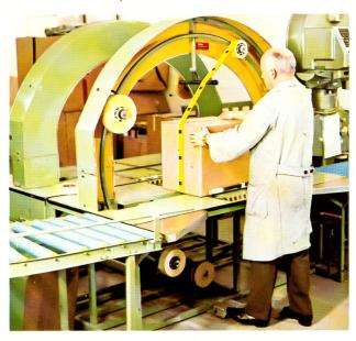
Für die Umreifung von schweren Packstücken mit tesafilm 144 oder tesafilm 154 wurde die tesa-Verpackungsmaschine 6041 geschaffen.
