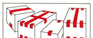
Anstelle des früher üblichen Doppel-T-Verschlusses setzen sich mehr und mehr Kombinationen von L- und U-förmigen Verschlüssen aus tesa Industrie-Klebebändern durch, sie erfordern keine langwierige Handarbeit, sondern können mittels einfacher Geräte zeitsparend angelegt werden. Für die L- und U-förmigen Verschlüsse werden tesa-Fabrikate in 38 und 50 mm Breite verwendet. Die Schenkel haben eine Länge von ca. 50 mm.
