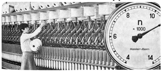
Elektrische Ferntachometeranlage für die Fernanzeige der Messwerte an einer oder mehreren Anzeigestellen; für den Einbau in stationäre oder mobile Anlagen.
