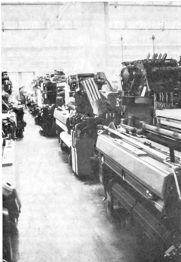
Spulenwechsel-Webmaschine Rütli, Typ C 1969, 4 Farben, 195 T/min, vollautomatischer Spulenwechsel
