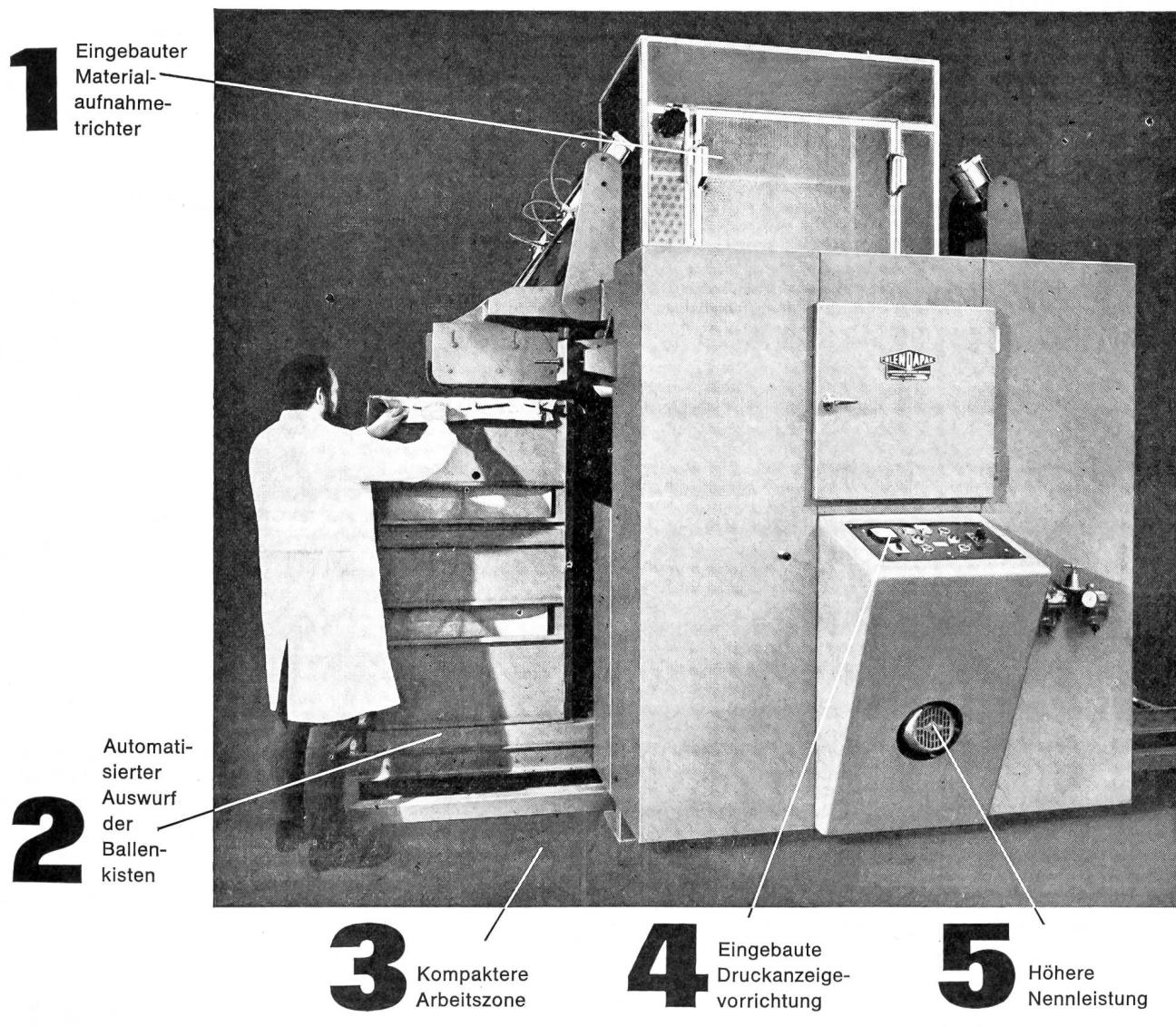
**1** Eingebauter Material-aufnahmeh-trichter
