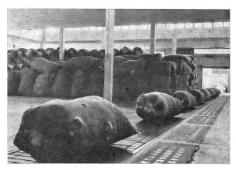
Bild 2 Förderbahn für Abgangsäcke
