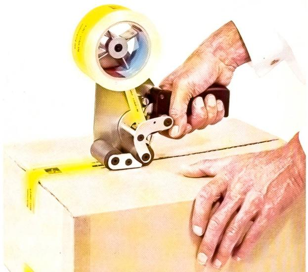
Abschneidevorrichtung. Der Packer setzt es auf die Schachtel und drückt das Streifen-Ende an. Jetzt braucht das Gerät nur über die Schachtel geführt zu werden – der tesafilm wird automatisch abgespult, angeklebt und durch einen Tastendruck abgeschnitten.
