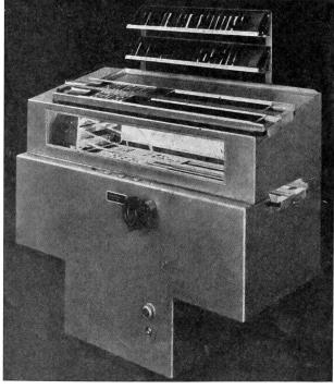
Abb. 2 Automat für zweizeilige Nameneinwebung in Frottiergewebe
