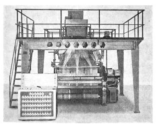
Abb. 1 Automat für einzeilige Nameneinwebung in Breitgewebe
