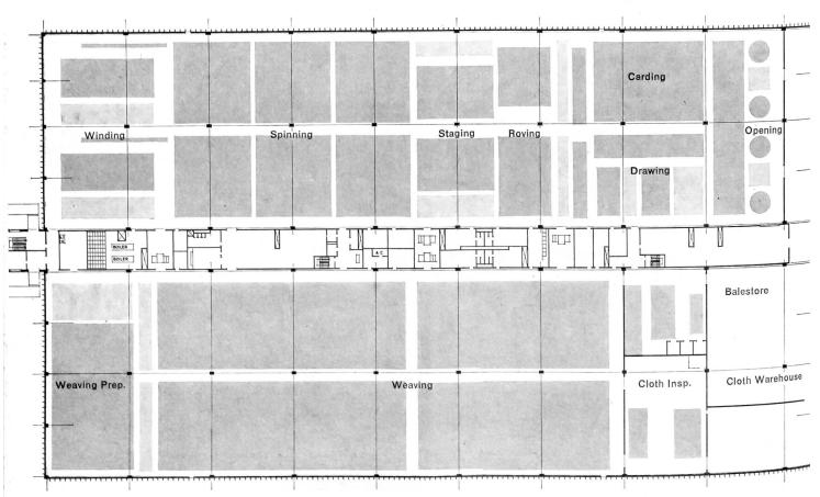
Grundriss und Maschinenaufstellung
