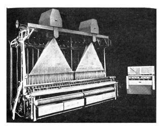
Abb. 6 Steuergerät für die Nameneinwebung in Schussbroschierung
