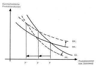
Abb. 2 Die beiden Kurven MK, und AK, stellen die Durchschnittskosten bei manueller und automatischer Fertigung (oder Datenverarbeitung) dar. P zeigt die Produktionsmenge (Datenmenge) bei der die Automation gegenüber dem manuellen Vorgehen kostengünstiger wird.
