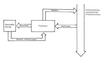
Abb. 1 veranschaulicht diese Zusammenhänge. Die zentrale Bedeutung des Rechners ist klar ersichtlich. Was aber ebenfalls auffällt, ist, dass Automation «tout court» die Koppelung zweier verschiedener Vorgänge bedeutet, nämlich der automatischen Steuerung und Ueberwachung der Produktion und der automatischen Datenverarbeitung.
