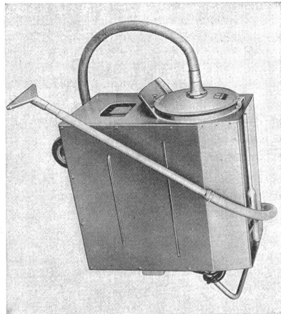
Beispiel eines Absaugapparates mit luftgekühltem Rotationskompressor, Typ C-2. Ein Hochleistungsgerät für schwere Absaugaufgaben zu Webstuhl und Spinnmaschinen (Schmiere, klebriger Flug, Oel usw.) 7,5 PS, 8000 mm WS, 340 m 3 /h, L×B×H = 120×47×95 cm
