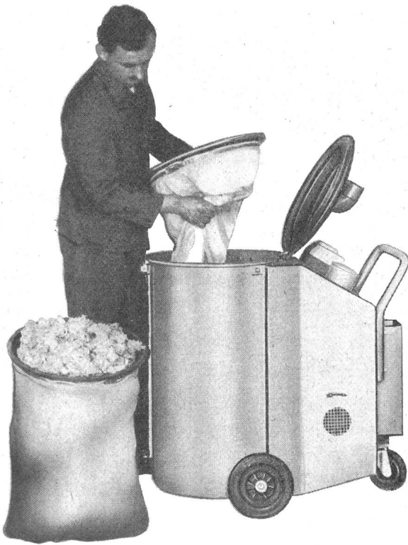
Beispiel eines mehrstufigen Turbogebläsesaugers mit Drehstromantrieb für Dauereinsatz, Typ SN-2000-T, 3 PS, 2000 mm WS, 300 m 3 /h, Masse: L×B×H, 91×55×99 cm
