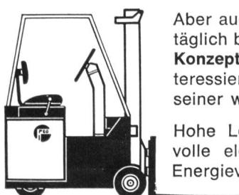
Leicht lenkbar und einfach zu bedienen. Wirkungsvolle hydraulische Bremsen. Leicht zugänglich. Unbedeutende Reparaturanfälligkeit bei einfacherem Unterhalt. 3-Rad-Konzeption und 2-Motoren-Antrieb — engster Drehradius, geringer Platzbedarf.
