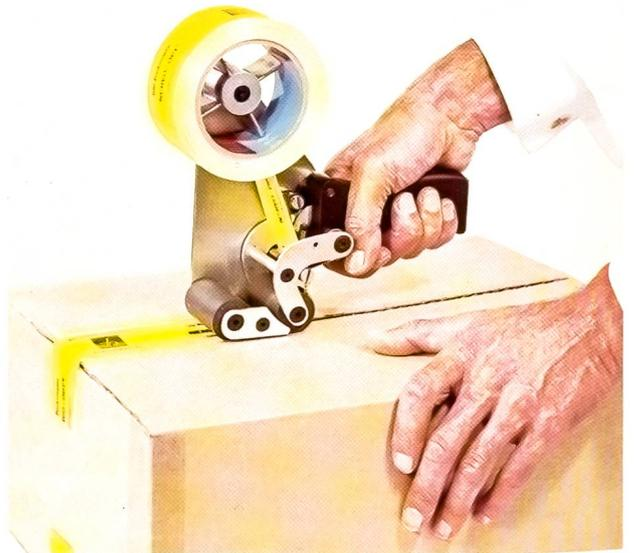
Abschneidevorrichtung. Der Packer setzt es auf die Schachtel und drückt das Streifen-Ende an. Jetzt braucht das Gerät nur über die Schachtel geführt zu werden – der tesafilm wird automatisch abgespult, angeklebt und durch einen Tastendruck abgeschnitten.
