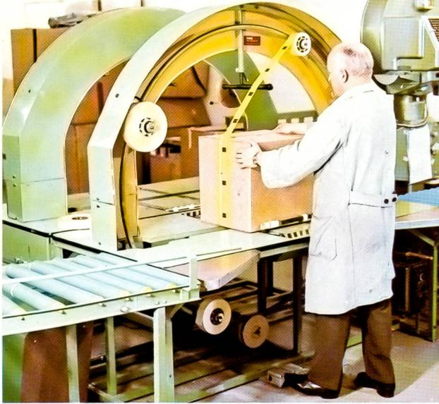
Für die Umreifung von schweren Packstücken mit tesafilm 144 oder tesafilm 154 wurde die tesa-Verpackungsmaschine 6041 geschaffen.
