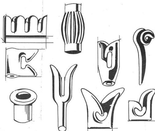
Fadenführer aus Porzellan, Hartkeramik, Glas oder Metall. Ballonfedern, Schützen-spindeln usw.
