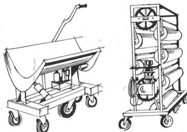
Hydr. Warenbaum-Hub- und Transportwagen System Schultheis für die verschiedensten Webmaschinenmodelle (Rüti, Saurer, Sulzer usw.) sowie Warenbaum-Sammelwagen für direkten Gewebeabzug in die Schau- oder Putzmaschine
