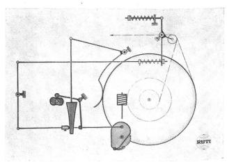
Abb. 8 Schematische Darstellung der Kettnachlassvorrichtung der Rüti-Webmaschine Typ B
