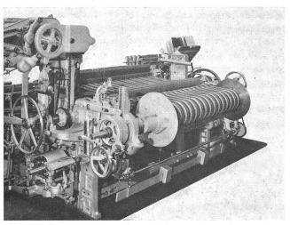
Abb. 7 Webmaschine mit Kettnachlassvorrichtung nach Abb. 6
