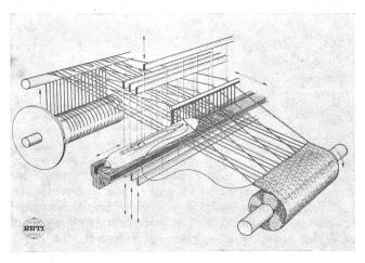
Abb. 1 Schematische Darstellung des Webprozesses
