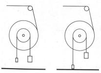
Abb. 4 Variante der Kettbaumbremse mit zwei Gewichten
