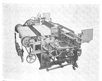
Abb. 5 Webmaschine mit Seilbremse und hochgelagertem Kettbaum
