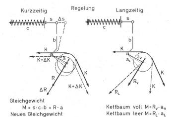
Abb. 9 Kräfteverhältnisse bei kurzzeitiger und langzeitiger Regelung an der Webmaschine Typ B
