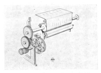
Abb. 2 Regulator der Webmaschine zur schrittweisen Aufwicklung des Gewebes
