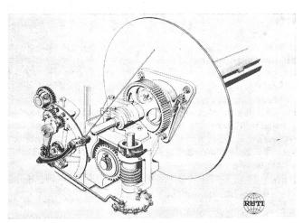
Abb. 13 Kettnachlassvorrichtung der Rüti-Webmaschine Typ C
