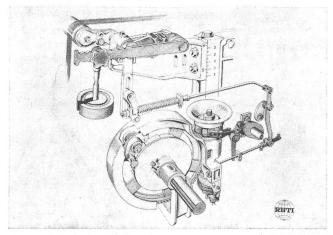
Abb. 11 Kettnachlassvorrichtung der Rüti-Webmaschine Typ S
