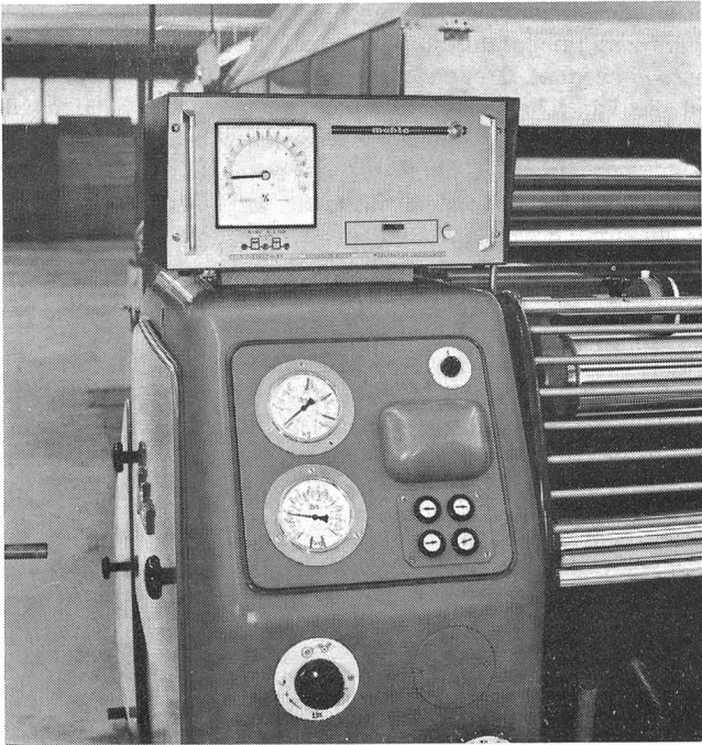
Abb. 11 Dehnungs- und Krumpfungsmessgerät (an einer Schlichtmaschine)
