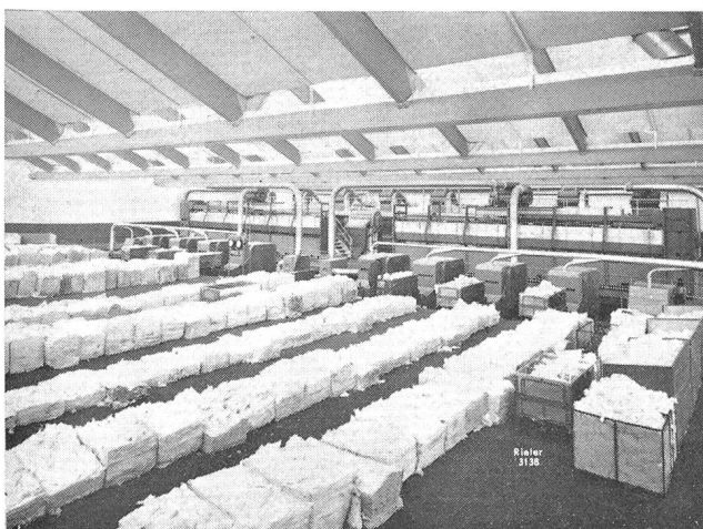
Abb. 2 Beschickung der Ballenöffner (Rieter)
