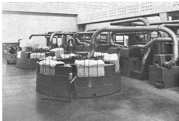
Abb. 3 Automatische Ballenabtragung mit «Karousel»® (Rieter)
