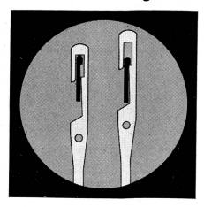
Die EMUTEX-Litzen sind durch die spezielle Form der Endösen und der Aufreihschienen gefangen und können somit auch bei extremer Belastung nicht aushängen. Sie verhindern Flugstaubansammlung und das Verhängen von Kettfaden. Die Auflagefläche auf den Aufreihschienen ist groß — dadurch minimaler Litzenverschleiß.
