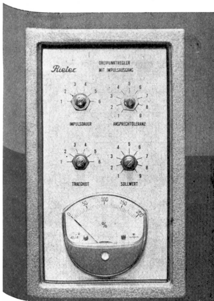
Abb. 19 Dreipunktregler für «Aerofeed»®-Regelkreis, eingebaut in Schaltschrank
