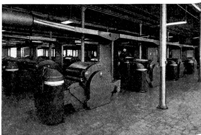
«Aerofeed»-Anlage mit Rieter Hochleistungskarden C 1/1, mit Bandablieferung in Einzelkannen (Bild 4)
