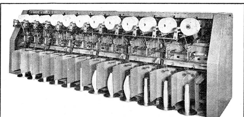
izisions-Kreuzspulmaschine für Reyon und synthetische Fäden
