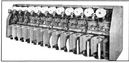
izisions-Kreuzspulmaschine für Reyon und synthetische Fäden 1100-2000 den., Hublängen von 150 oder 200 mm, konische oder zylindrische Kreuzspulen mit geraden Stirnflächen und Issem Garninhalt, raumsparende Maschinenteilung von 300 mm.
