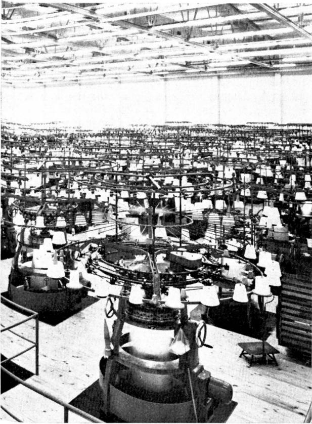
Wirkerei und Strickerei — auf mehreren hundert Rundmaschinen wird das gespulte Baumwollgarn zu Schlauchwaren in verschiedenen Breiten verarbeitet. Sechs bis acht Maschinen werden von einer Arbeitskraft bedient
