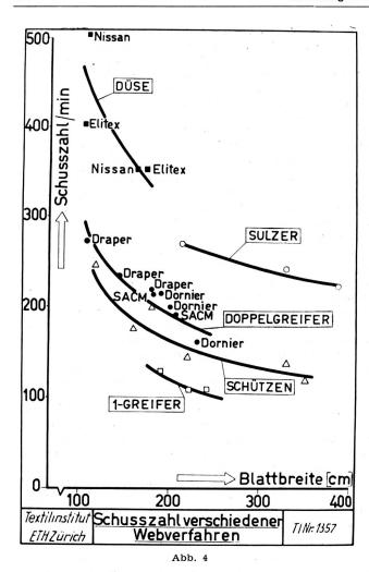
steht es in dieser Beziehung bei den Greiferwebmaschinen? Im Gegensatz zum frei fliegenden Schusstransportmittel — sei es der Spulenschütze, Schleppschütze oder ein Projektil — steht für die Beschleunigung des Greifers eine relativ grosse Zeitspanne zur Verfügung, da die Maximalgeschwindigkeit ja erst innerhalb des Faches erreicht werden muss. Deshalb arbeiten solche Maschinen verhältnismässig ruhig, obschon relativ grosse Massen zu bewegen sind.
