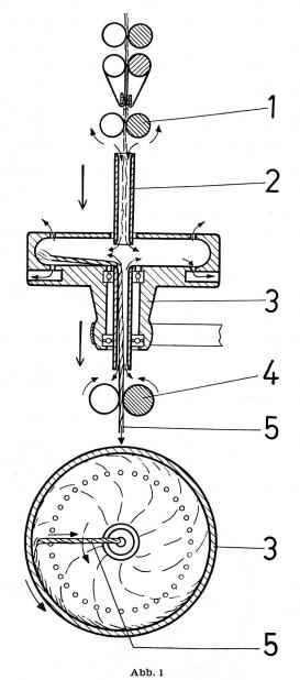
Zentrifugen-Spinnverfahren 1 Streckwerk 2 Transportstrecke 3 Zentrifuge 4 Abzugswaizen 5 Garn
