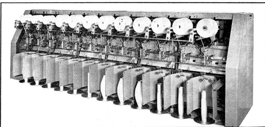
Präzisions-Kreuzspulmaschine für Reyon und synthetische Fäden
