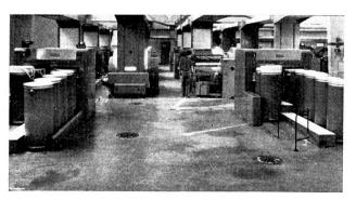
Im modern eingerichteten Spinnereisektor beeindruckte die moderne Karderie, ausgerüstet mit Rieter Hochleistungskarden C 1/1 und wickelloser Kardenspeisung System «Aerofeed»
