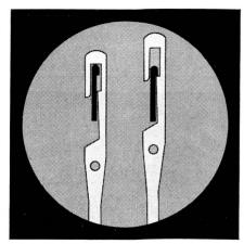
Durch ein Verschieben des Endstückes können die Aufreihschienen freigelegt und ausgeschwenkt werden. Dadurch können die Litzen rascher aufgereiht und abgestoßen werden.
