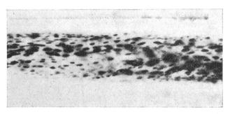
Abb. 9: Vistralan XT nach Spezialfärbung mit Viktoriablau 4 R Eingelagerte und beim Spinnen längsverstreckte Eiweißteilchen dunkelblau angefärbt. 800:1
