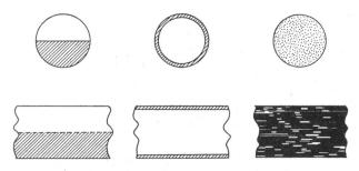
Abb. 8: Möglichkeiten der Bildung von Bikomponentenfasern. Links: Herstellung aus einer Doppeldüse wie Abbildung 5; Mitte: Herstellung aus einer Ringdüse; rechts: Matrix/Fibrillen-System. Oben jeweils Querschnitt, unten Längsschnitt
