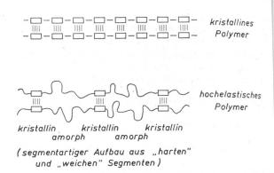
Abb. 12: Aufbauschema kristalliner und hochelastischer Polymere (nach Oertel)
