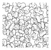
Abb. 6: Orlon 21, Zweikomponenten-Acrylfaser (eine Komponente leicht mattiert). Querschnittzeichnung 300:1
