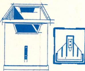
Schußspulenbehälter aus Kunststoff für Schärer- oder Schweiter-Spulautomaten, Rüti-Großmagazinautomaten, +GF+/ALV oder Saurer-Kastenlader (stapelbar, schlag- und bruchfest, form- und alterungsbeständig, für Spulenlängen 190, 200, 210 und 220 mm)
