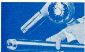
2. Heissluftgebläse gleichmässig über Schrumpfschlauch führen.
