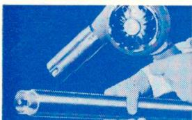
2. Heissluftgebläse gleichmässig über Schrumpfschlauch führen.
